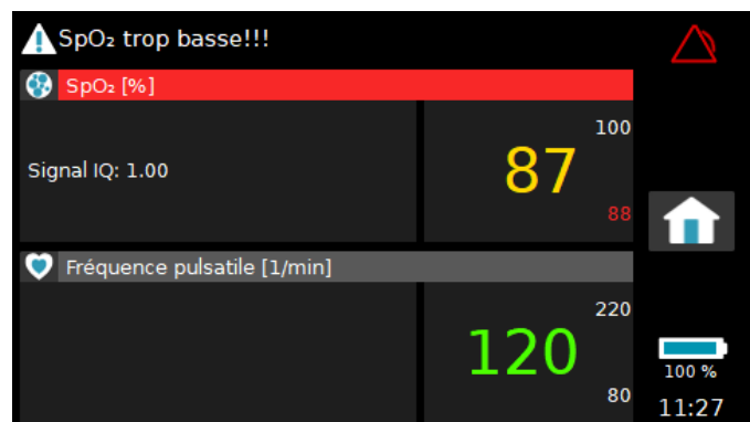
Fig. 32 Informations sur l'écran du moniteur pendant une alarme patient
