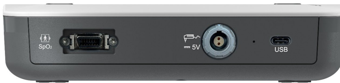
Fig. 7 Panneau des connecteurs VitaGuard
