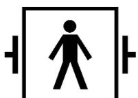
Das Symbol neben dem Anschluss weist darauf hin, dass der Anschluss als "Body Floating" (BF) klassifiziert ist und gegen Defibrillation geschützt ist.
