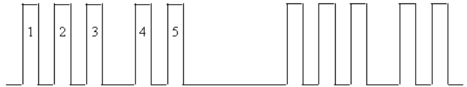
Fig. 24 Caractéristiques du signal d'alarme sonore pour les alarmes patient
