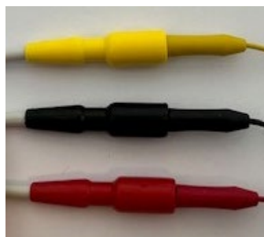
Fig. 20 Farbcodierte Buchsen am Verteiler des EKG-Patientenkabels
