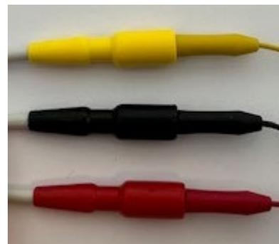
Fig. 20 Farbcodierte Buchsen am Verteiler des EKG-Patientenkabels
