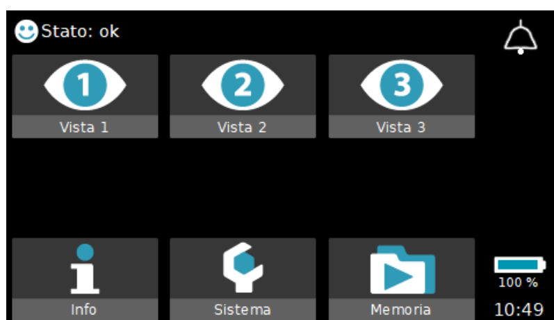
Fig. 77 Schermata iniziale con protezione impostazioni attivata e visualizzazioni 2 e 3 impostate su acceso
