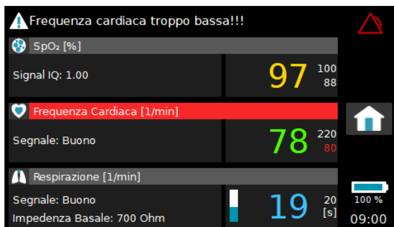
Fig. 38 Informazioni sullo schermo del monitor durante un allarme paziente
