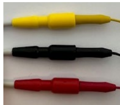
Fig. 33 Farbcodierte Buchsen am Verteiler des EKG-Patientenkabels
