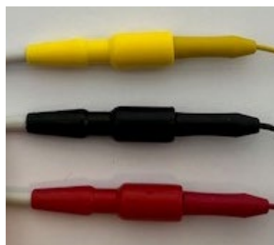
Fig. 33 Prese con codice colore sul cavo ECG paziente
