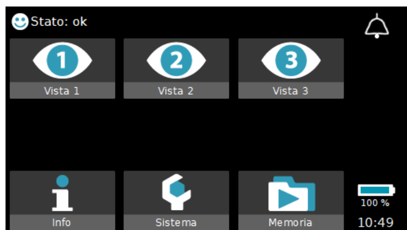
Fig. 76 Schermata iniziale con protezione impostazioni attivata e visualizzazioni 2 e 3 impostate su acceso
