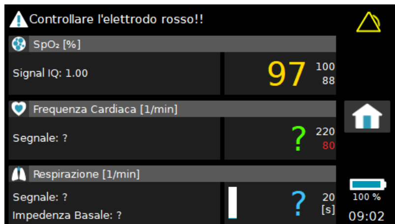
Fig. 39 Informazioni sullo schermo del monitor durante un allarme tecnico
